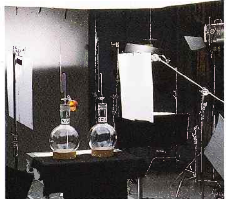
Studioaufbau des Versuchs, mit dem die unterschiedliche Aufnahme von Wärmestrahlung von Luft und FCKW demonstriert wird.
